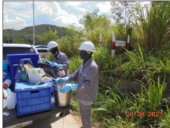
รูปที่ 3.12 การเก็บตัวอย่างคุณภาพน้ำใต้ดิน บริเวณพื้นที่โครงการด้านทิศเหนือ (GW1)
